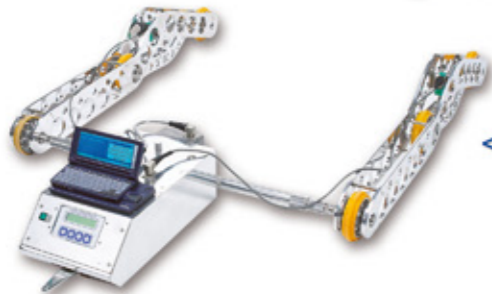
< Medidor del desnivel transversal
